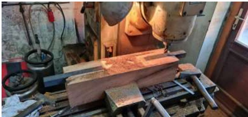
8.kép A képen a Gombos harangöntődében a készülő a felülütős fa harang harangkorona
