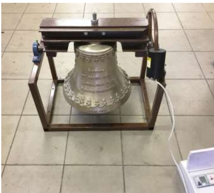
25. kép Tartókeretre szerelt íves húzómű
